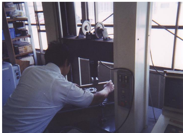
写真7 曲げ試験の作業風景
